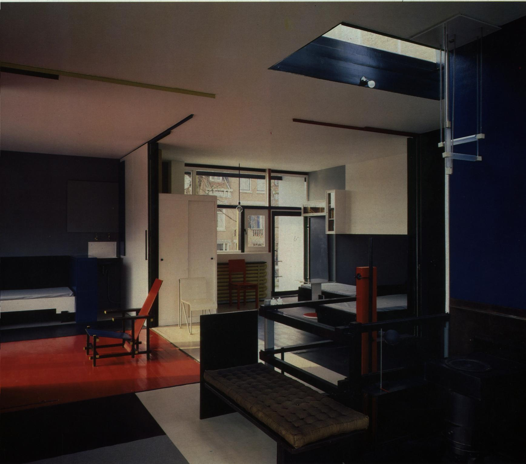
5. 6. Interior en dos versiones de compartimentación a base de paneles deslizantes
